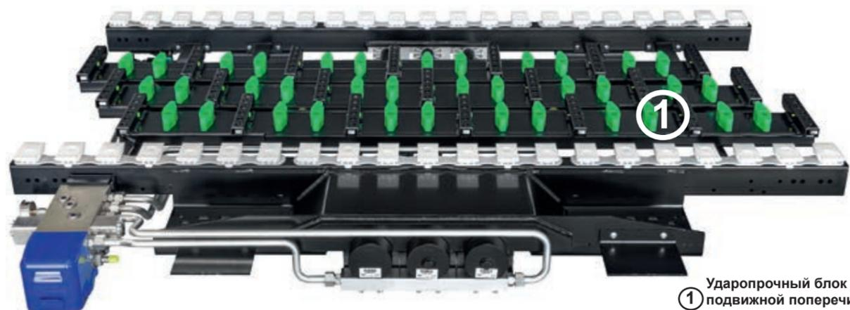
① Ударопрочный блок для подвижной поперечины (зеленая)
