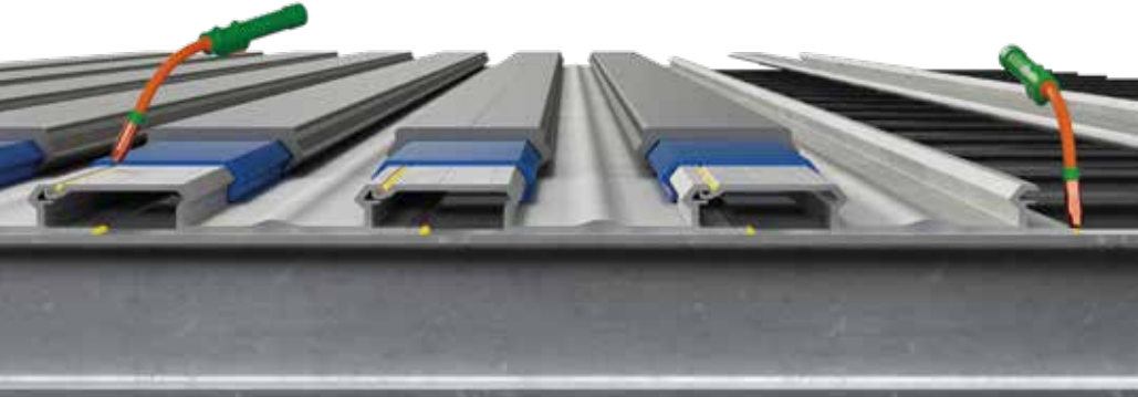
Lames de plancher « Slide in » soudées sur des traverses en aluminium (ou rivetées), scellées par des soudures sur toute la longueur.
