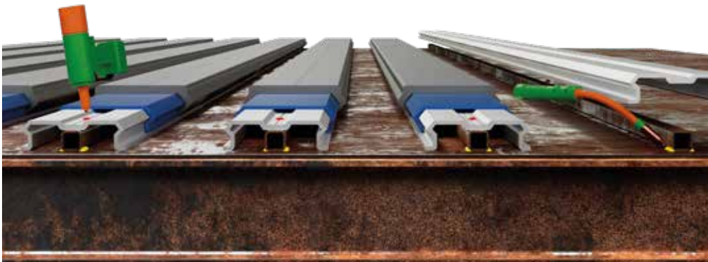
Lames de plancher amovibles en aluminium, rivetées sur un profilé en caisson en acier soudé à une tôle d'acier.
