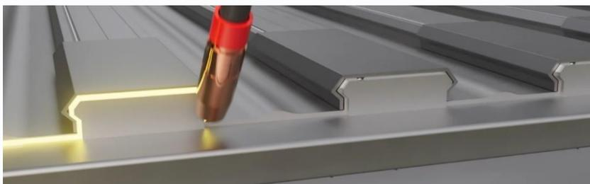
No lado do painel de proteção da cabina, a base pode ser soldada ou selada, seguindo os contornos (fig. 29 C). Além disso, a ranhura em V nos primeiros 50 mm a partir do painel de proteção da cabina deve ser soldada e terminada suavemente.
