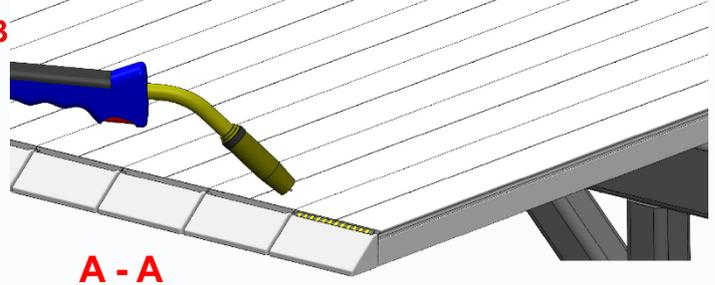
**Paso 2:** Sólo cuando monte los perfiles en el remolque deslizándolos horizontalmente desde atrás, le recomendamos que redondee los bordes delanteros del perfil, fig. 2. Cuando monte los perfiles verticalmente desde arriba puede omitir este Paso.
