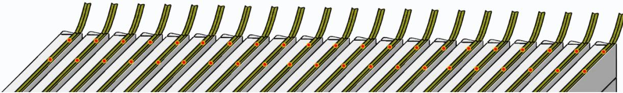
**Paso 6:** Tire de la junta hasta la tensión correcta, fig. 6.1, estirándola y luego empuje la junta hacia abajo para bloquearla, a continuación fije la junta con una pistola de clavos o un remache (2 piezas). Véase la figura 6.2.
