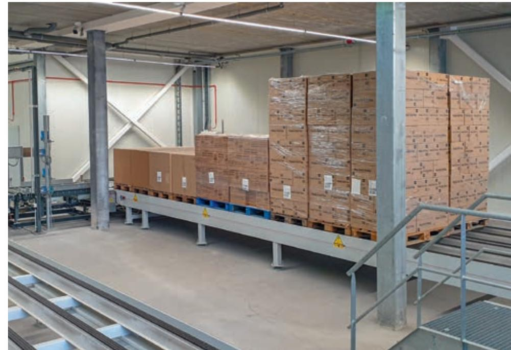
Transportador de correntes CargoMatic para Serviço Pesado com 6 correntes triplex.
