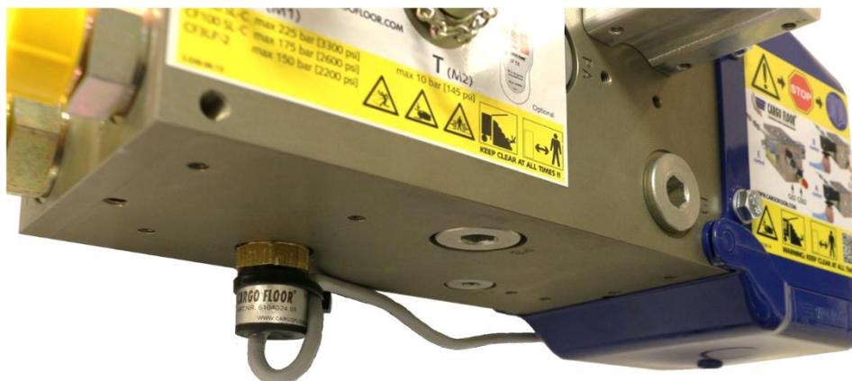
На этом монтаж предохранительного выключателя для защиты от превышения температуры масла Cargo Floor завершен.
