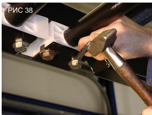
Теперь можно установить на место трубопроводы и затянуть соединительные муфты настолько, чтобы предотвратить утечку (рис. 39 – 40).
