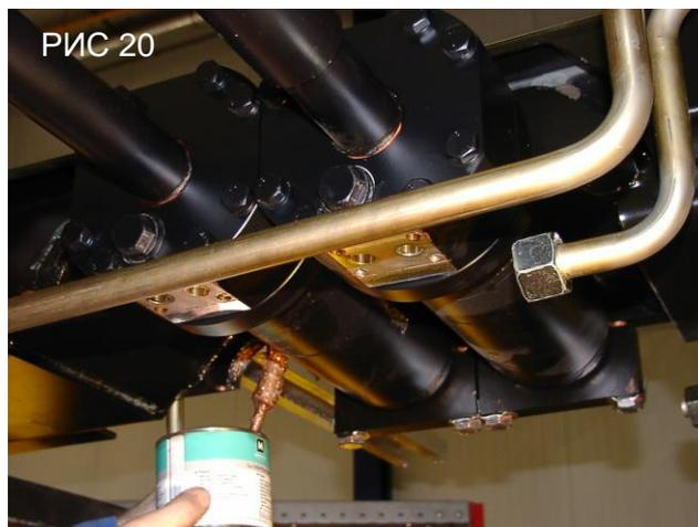
Теперь с участием двух помощников можно подвесить новый цилиндр на его место. Потребуется опять покачать цилиндр из стороны в сторону для того, чтобы цилиндр мог пройти мимо расположенных под ним гидравлических трубопроводов. Первой установите прижимную пластину, которая была снята последней при ручном демонтаже. Теперь цилиндр подвешен на своем месте.
