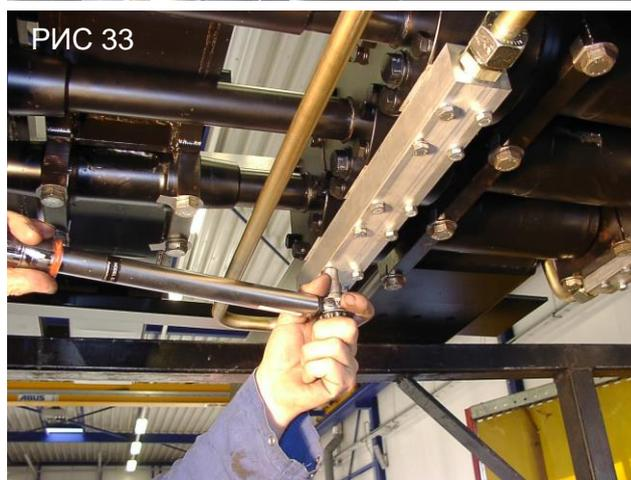
Теперь можно окончательно закрепить все прижимные пластины на своих местах. Убедитесь, что прижимные пластины установлены по горизонтали. После того как болты будут завернуты пневматическим гайковертом, необходимо затянуть их с помощью динамометрического ключа. Болты прижимных пластин затягивают до момента 150 Нм (рис. 34 – 35), а болты направляющего блока затягивают моментом 100 Нм (рис. 36).
