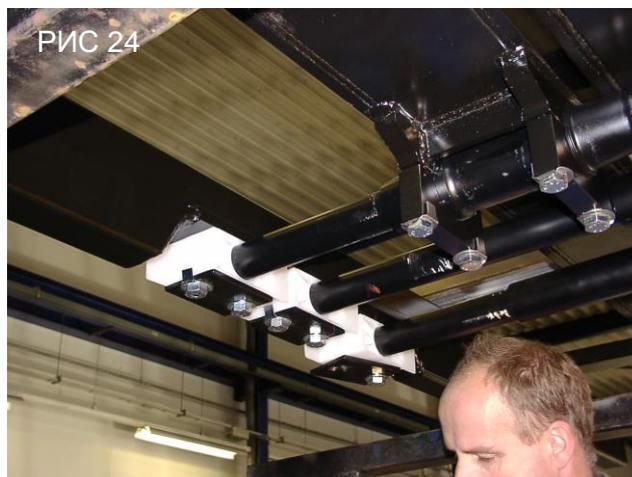
должен быть установлен примерно в той же позиции, что и цилиндр рядом с ним. Для этого сравните положения передних поверхностей крышек цилиндров (рис. 26).
