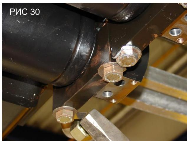
Теперь можно установить общие рамы с новыми уплотнениями. Следите за тем, чтобы заглушки в общей раме были установлены в нужных местах (рис. 32). (Общие рамы имеют асимметричную форму). Установите пружинные шайбы на болты общей рамы и нанесите на них небольшое количество медной смазки. Теперь следует затянуть болты (24x) на обеих рамах до момента 30 Нм (использовать динамометрический ключ на 13, см. рис. 33).
