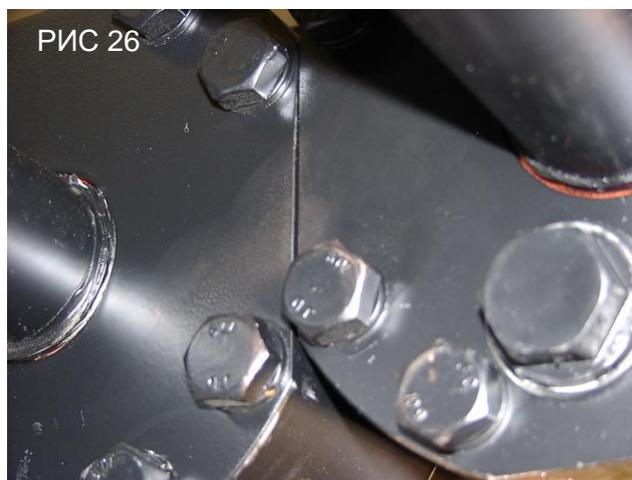
Шток цилиндра должен быть установлен в правильное положение. Это означает, что резьба штока находится приблизительно в середине прижимной пластины, фиксирующей подвижную поперечину. Кроме того, сварка втулки должна располагаться горизонтально (рис. 27). С помощью трубного ключа можно повернуть шток таким образом, чтобы обеспечить возможность перемещения штока по резьбе.
