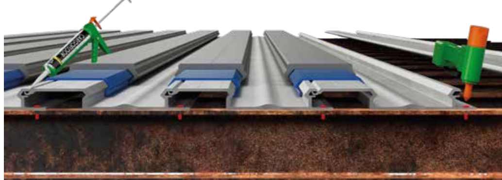
алюмооксидные профили "Slide in" приклепаны к стальным поперечинам и закрыты герметиком.
