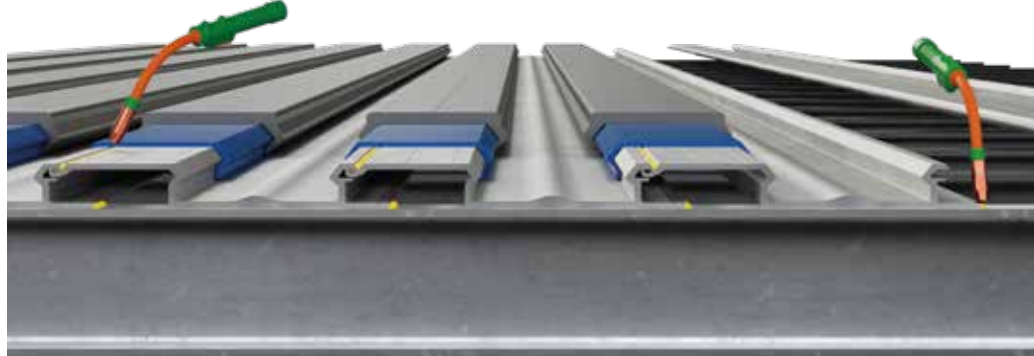
профили "Slide in", приваренные к алюминиевым поперечинам (в качестве альтернативы - клепаемые), уплотненные сварными швами по всей длине.
