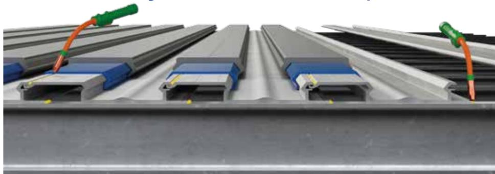
Perfis de sub-plataforma "deslizantes" soldados em travessas de alumínio (em alternativa, rebitados), selados por soldaduras a todo o comprimento.
