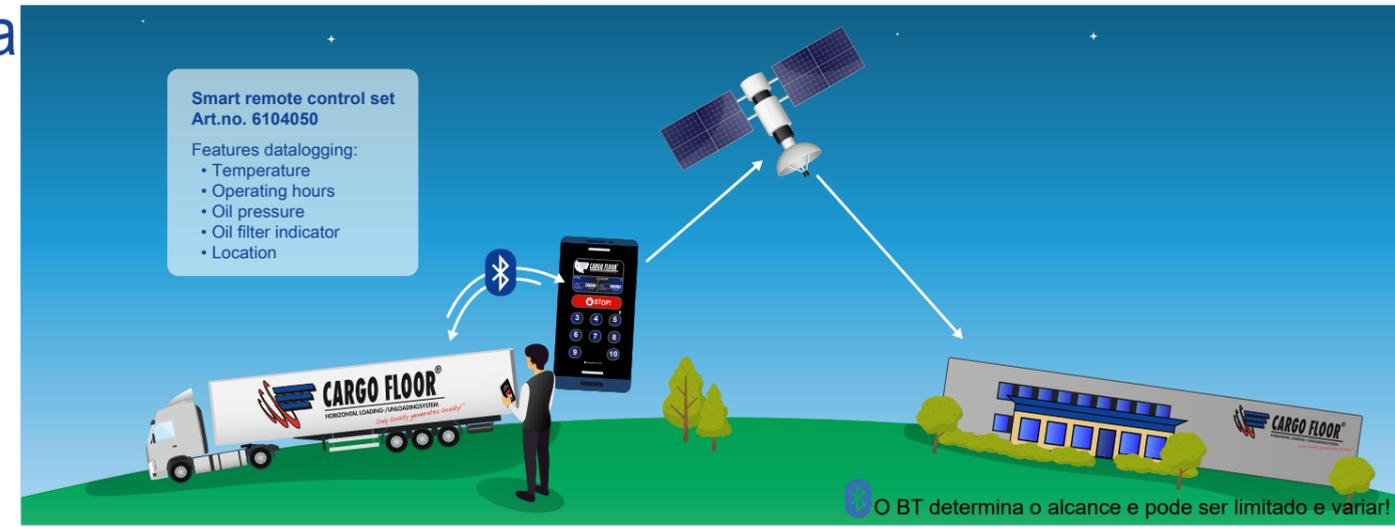
Os sistemas Cargo Floor podem ser fornecidos com um **Módulo de Controlo Remoto Inteligente (IRCM)** no qual foram incluídas muitas funcionalidades. Dependendo das opções, os seguintes itens podem ser operados através de um toque à prova de água (IP67) painel de controlo sensível. Desenvolvido inteiramente pela Cargo Floor.
