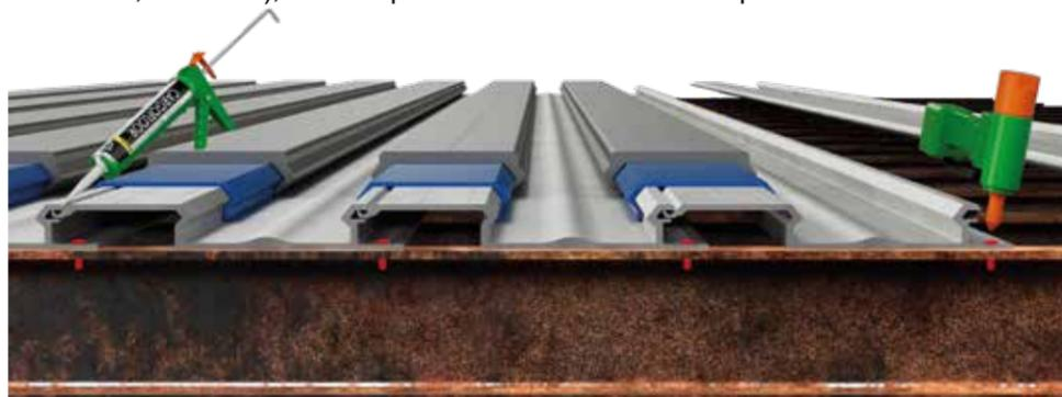
Perfis de sub-deck em alumínio "deslizantes" rebitados em travessas de aço e selados com selante.
