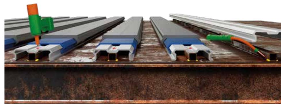
Perfis de alumínio soltos do subdeck rebitados numa secção de caixa de aço soldada a uma placa de aço.
