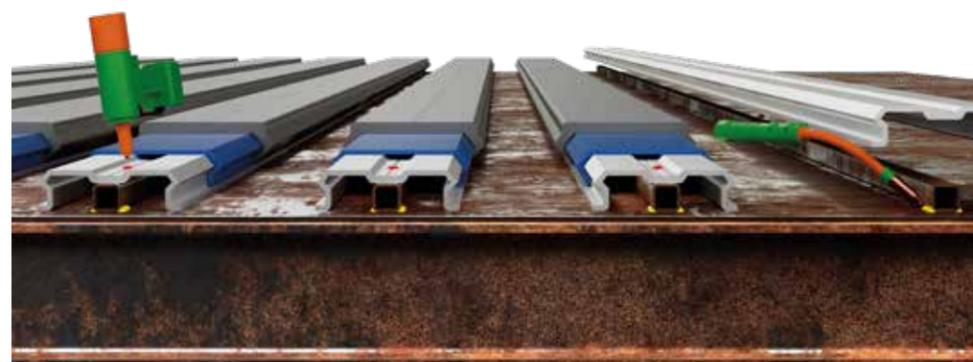
Profili di sottoponte in alluminio sciolti rivettati su una sezione scatolare in acciaio e saldata a una piastra in acciaio.
