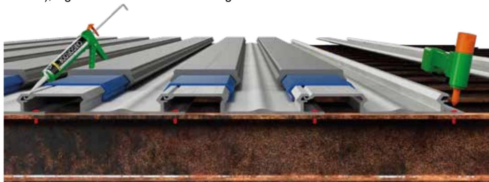
Pvprofili di sottocoperta in alluminio "a scorrimento" rivettati su traverse in acciaio e sigillati con sigillante.
