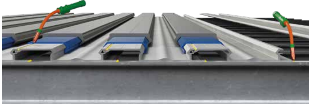
Profilés de sous-ponts "glissés" soudés sur des traverses en aluminium (alternativement rivées), scellés par des soudures sur toute la longueur.
