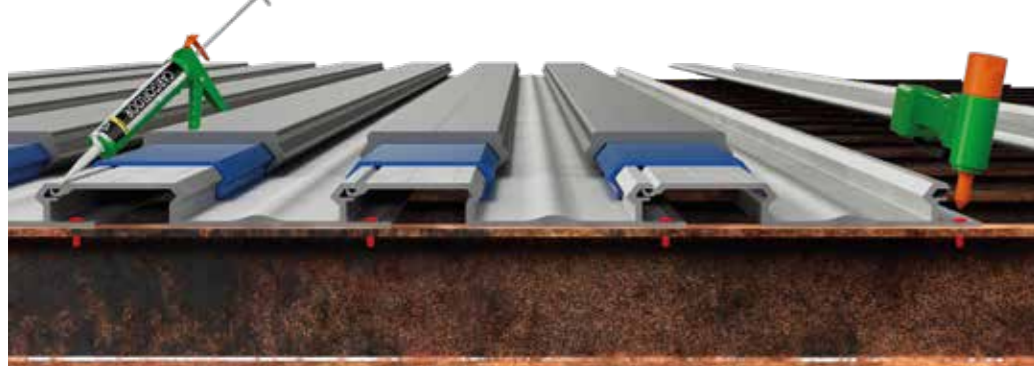
Profilés de sous-ponts en alu "Slide in" rivés sur des traverses en acier et scellés avec un produit d'étanchéité.
