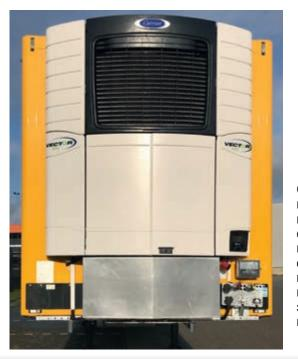
Сверхкомпактный приводной блок CargoMatic всегда устанавливается снаружи поперечной перегородки прицепа, что обеспечивает максимальное пространство для загрузки в прицепе. Кожух защищает этот сверхкомпактный привод от грязи и воды.
