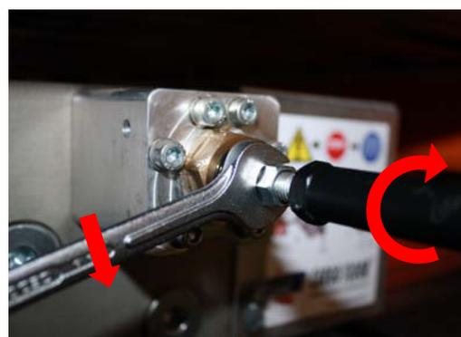
Kontrolliere das Druckfilterelement und ersetze diese wenn defekt oder verschmutzt.
