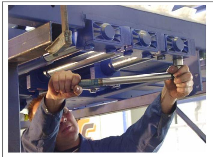
Ziehen Sie die Schrauben der "Common Rails" (24 x) mit 30 Nm fest (Schlüssel SW 13).
