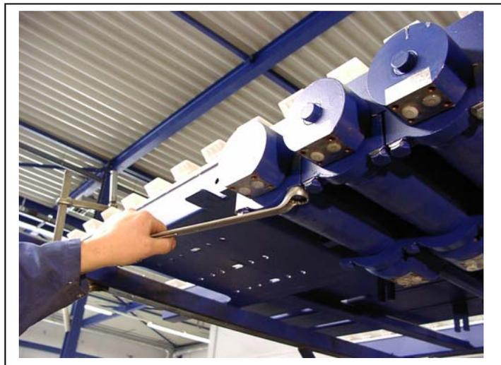
Entfernen Sie diese Schrauben noch nicht, sondern lösen Sie sie nur so weit, dass sie von Hand herausgedreht werden können.
