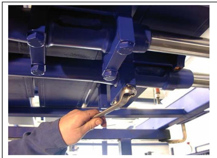
Entfernen Sie eine Klemmschale und lockern Sie die anderen Schrauben so weit, dass sie von Hand entfernt werden können.
