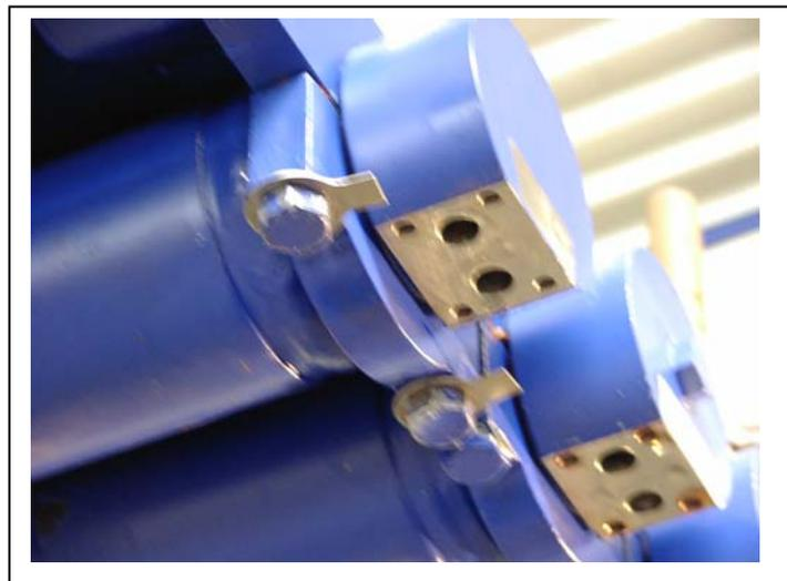
Bauen Sie danach die einfache Klemmschale beim Zylinderboden ein und drehen Sie beide Schrauben einige Umdrehungen an (Abb. 33.0).
