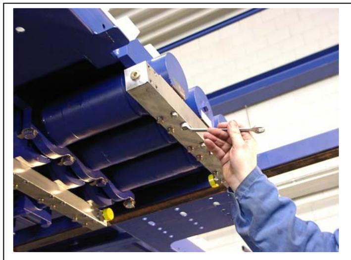
Wenn diese in Ordnung sind, befestigen Sie die "Common Rail" auf beiden Seiten. (Abb. 38.)
