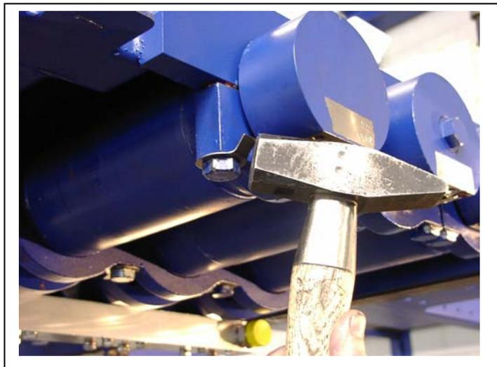
Entfernen Sie alle Stopfen aus den Zylindern und der "Common Rail".
