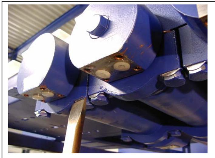
Nach dem locker klopfen der Scheiben mit Lappen können die Schrauben der Dreifach-Klemmschale (4 x M 16 x 90) gelöst und entfernt werden (Abb. 24.0).
