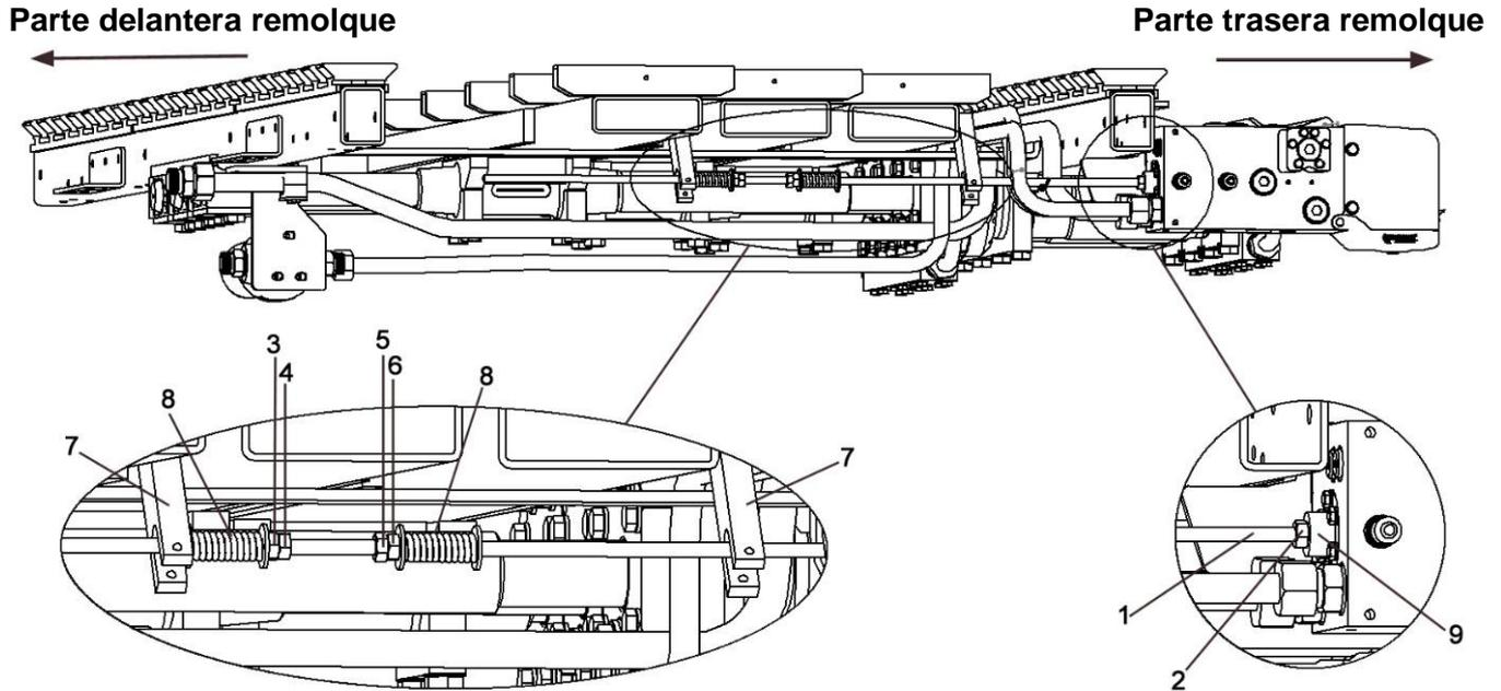
Todos los sistemas Cargo Floor tienen el juego de varillas roscadas y se han comprobado íntegramente. Por consiguiente, no necesita ajustar la varilla roscada, pero en ciertas circunstancias (p. ej. ciertas reparaciones) puede que haga falta comprobar o modificar el ajuste de la varilla roscada. Si no se produce normalmente la conmutación de forma espontánea, entonces haga primero una buena valoración de por qué ha ocurrido esto.
