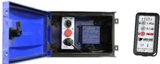
**Commande B** avec chargement / arrêt / déchargement via un levier manuel, avec mécanisme de détente **"S" unique** permettant de déterminer la position de chargement / arrêt / déchargement. Mise sous/hors tension avec un interrupteur. Muni par défaut d'un asservissement manuel grâce à un sélecteur rotatif rouge unique "Cargo". (Option : télécommande radio)
