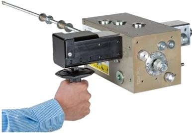
**Control A** con carga / parada / descarga a través de una palanca manual, con **un mecanismo de trinquete "S"** único para determinar la posición de carga / parada / descarga. (No eléctrico).
