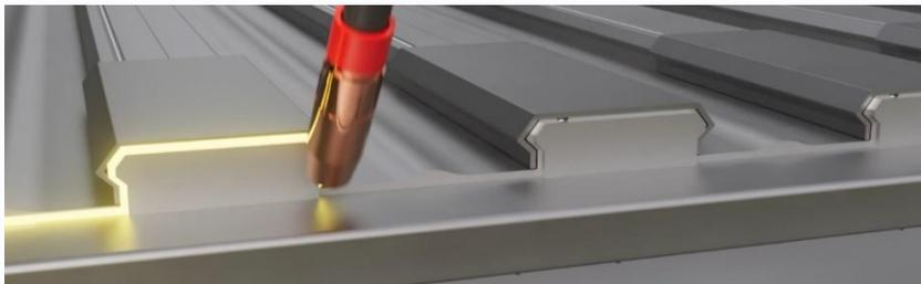
En el lado del cabecero, el subsuelo puede soldarse, o sellarse, siguiendo los contornos (fig. 29 C). Además, la ranura en V a 50 mm [2"] del cabecero debe soldarse y cerrarse suavemente..
