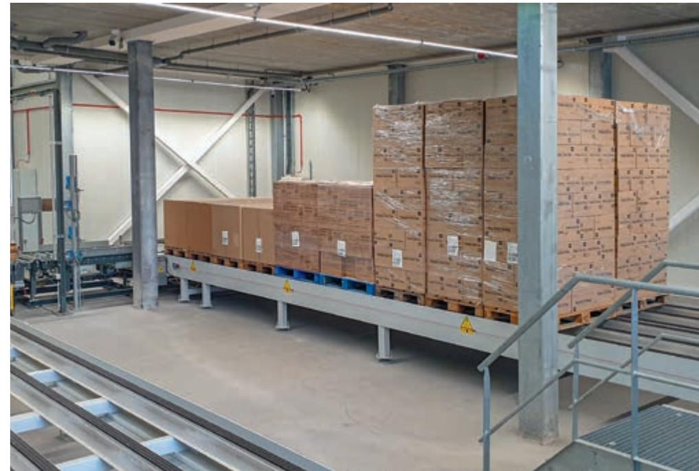
Nastro trasportatore a catena CargoMatic in esecuzione a Heavy Duty con 6 catene triplex.
