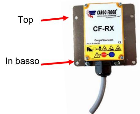
Avvitare poi la piastra di montaggio con il ricevitore sulle cupole nella scatola di controllo con le 4 viti 4x14.
