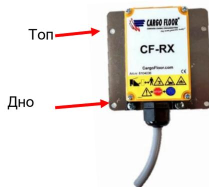
Затем прикрутите монтажную пластину с приемником к куполам в блоке управления с помощью 4 винтов 4х14.
