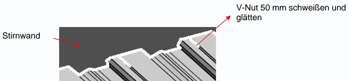
Nun kann die Naht zwischen den Seitenprofilen und den Wänden verschweißt oder verklebt werden. Nachdem alle Unterbodenprofile rundherum versiegelt sind, muss die Naht auf der Oberseite der Wölbung überprüft werden, um festzustellen, ob sie ausreichend versiegelt ist. Möglicherweise muss die Naht an einigen Stellen weiter abgedichtet werden, siehe Abb. 30.
