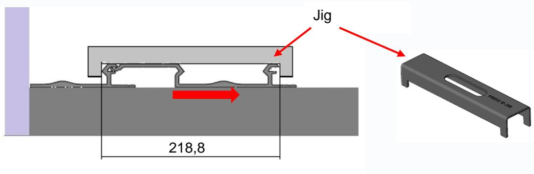
Schieben Sie das Profil ein und ziehen Sie es dann gegen die vertikalen Lippen der Form.
