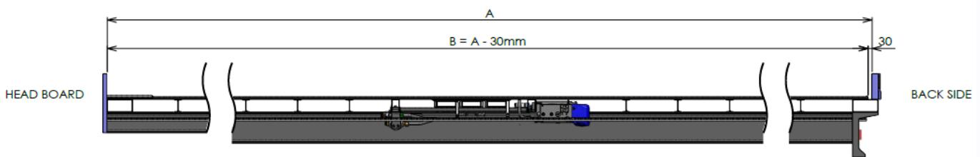
Die Länge des T-subdecks wird bestimmt durch den Raum im Auflieger. Wenn es möglich ist wird das Maß von Innenseite der Stirnwand bis zu der Innerseite der Türe bestimmend sein. Dies nennen wir Maß **A**.
