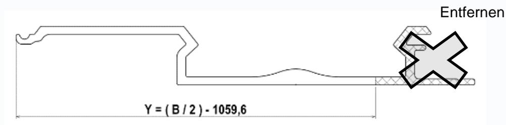
Sie teilen den verfügbaren Raum (beachte Obstakel und gewählte Nahtgröße) durch zwei und ziehen davon für das linker Seitenprofil 1110 mm von diesen Wert ab. Der Wert die dann übrigbleibt ist die Breite des linken Seitenprofils.
