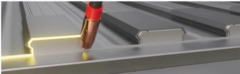
Auf der Kopfteilseite kann der Unterboden verschweißt oder versiegelt werden, indem man den Konturen folgt (Abb. 29 C). Außerdem sollte die V-Nut auf den ersten 50 mm von der Stirnwand geschlossen und geglättet werden.
