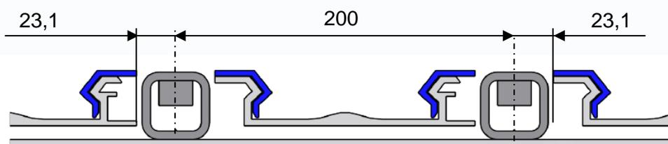
Für die Position dieser Öffnungen in den Leak Proof Subdeckprofile können Sie die Maßführung in Abb. 19 A und B anwenden. Bei dem linken Seitenprofil braucht das wegzuschneiden Teil nur an der rechteren Seite gemacht zu werden und bei dem rechteren Seitenprofil braucht nur an der linken Seite ein Teil weggeschnitten werden. Alle übrigen Leak Proof Subdeckprofile werden an beide Seiten dieses Teil weggeschnitten. Die Position und Länge der Aussparung ist gleich für alle Subdeckprofile.
