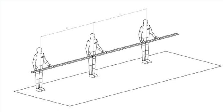
Während der folgenden Arbeiten und Vorbereitungen müssen Sie damit Rechnung halten dass sowohl die Unterprofile als die Oberprofile auf eine derartige Weise getragen werden sollen dass diese nicht knicken oder auf einer anderen Weise beschädigen. Wir raten an um umräumen oder kanteln mit zumindest drei Personen auszuführen.
