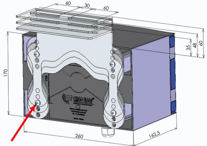
Flanschkopfschraube, PZ, für Kunststoff, 6x20 mm
