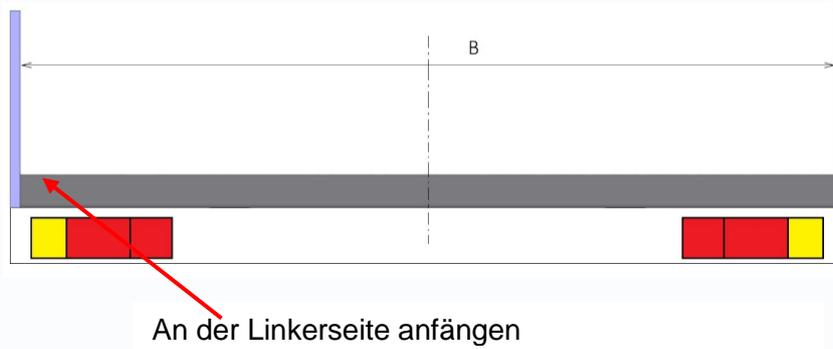
Der Einbau soll von links nach rechts ausgeführt werden müssen.
