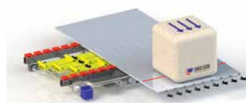
L'étape 1 est répétée à nouveau. La vitesse à laquelle ces étapes sont répétées peut être ajustée en fonction du débit d'huile hydraulique.
