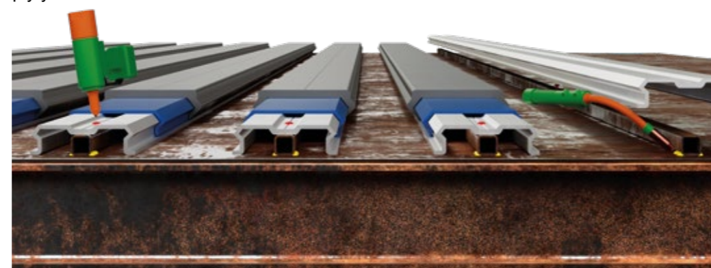
Luźne aluminiowe profile podkładowe nitowane na stalowej sekcji skrzynkowej przyspawanej do stalowej płyty.
