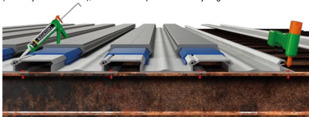
"Wsuwane" aluminiowe profile podkładowe nitowane na stalowych belkach poprzecznych i uszczelnione szczeliwem.
