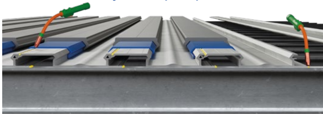
"Wsuwane" profile podkładowe przyspawane do aluminiowych belek poprzecznych (alternatywnie nitowane), uszczelnione spawami na całej długości.
