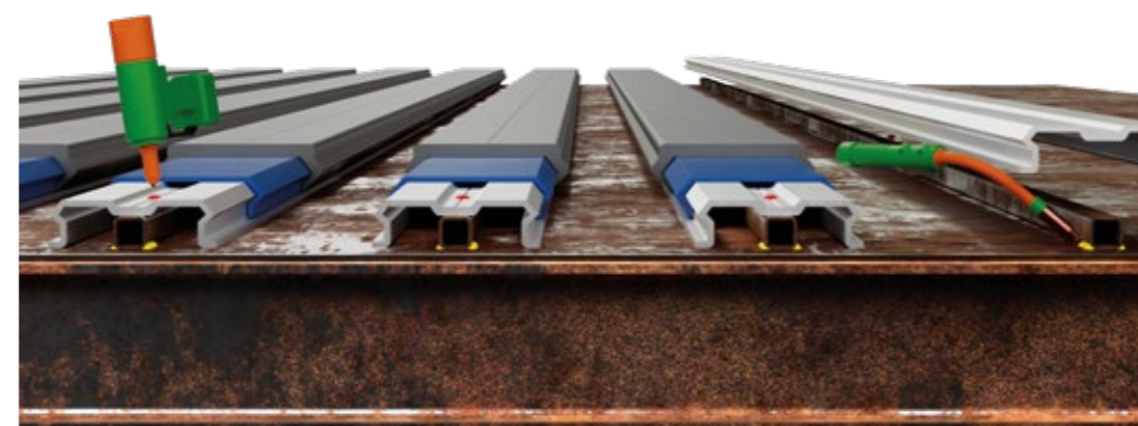
Profili di sottoponte in alluminio sciolti rivettati su una sezione scatolare in acciaio saldata a una piastra in acciaio.
