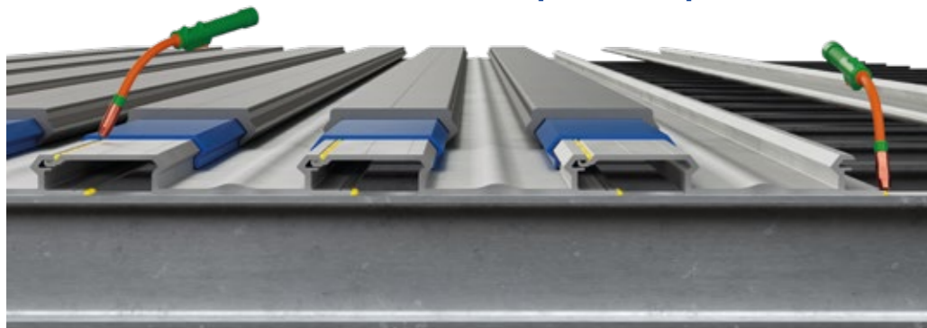
Profili di sottoponte "a scorrimento" saldati su traverse in alluminio (in alternativa rivettati), sigillati da saldature a tutta lunghezza.
