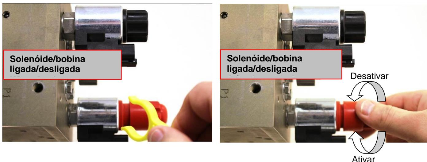
Se a unidade de transmissão não ligar ao utilizar a sobreposição de emergência, então a avaria é de natureza elétrica.
