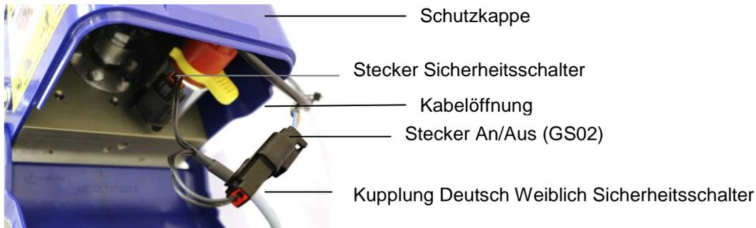
Ziehe den schwarzen Stecker aus der An/Aus Spule GS02 (= der Spule mit der roten Notbedienung). Dies macht man durch das Eindrücken der Sicherungslippe und dann am Stecker zu ziehen. Dieser Stecker dann in die schwarze Kupplung, weiblich, vom Kabel des Sicherheitsschalters drücken bis der Sicherungslippe in der Sicherung rein klickt. Stecke jetzt den übergebliebenen schwarzen Stecker der Sicherheitsschalter in die Kupplung der An/Aus Spule GS02.
