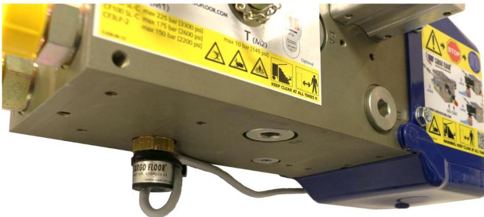
Die Montage der Öltemperatur Sicherheitsschalter ist jetzt fertig.
