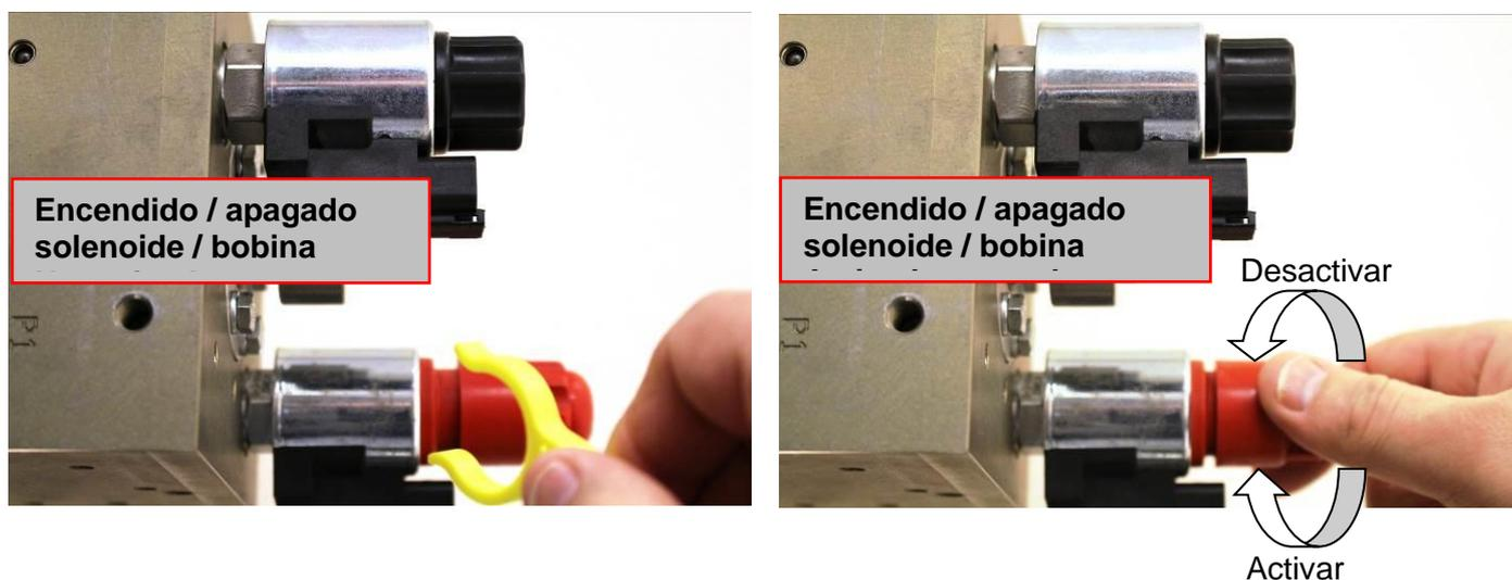
Si se enciende la unidad de accionamiento al utilizar el control de emergencia, la avería es de tipo eléctrico.
