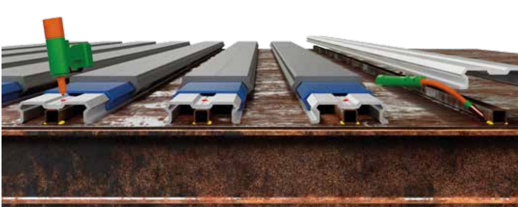
Profil subdeck aluminium longgar yang diikat pada bagian kotak baja yang dilas ke pelat baja.
