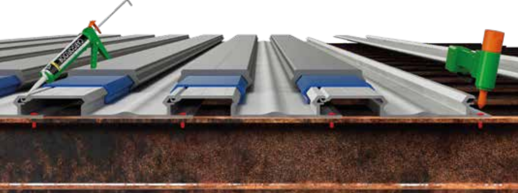
"Geser ke dalam" profil subdeck alu yang direkatkan pada anggota silang baja dan disegel dengan sealant.
