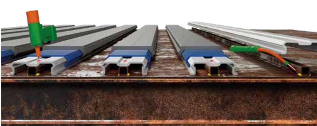
Lösa underdäckprofiler i aluminium nitade på en stålboxprofil svetsad till en stålplatta.
