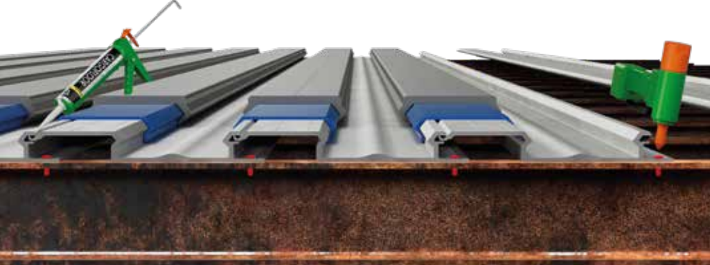
"Slide in" underdäckprofiler av alu som nitats på tvärbalkar av stål och tätats med fogmassa.
