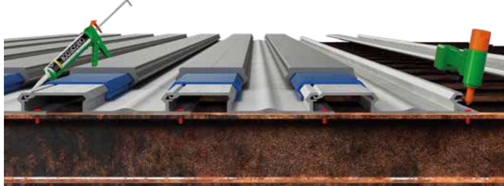
يذالوف ضراروع ىلع ةتبتشمل موينمولال نم ةعونصلما يلفسلا حطسلا بناوج "يف قالزنا" برسئلل ةعنام ةتامب ةموتخمو
