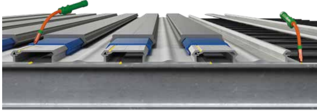
لكشب اطبر متي وا) موينمولال ضراروع ىلع ةمولم يلفسلا حطسلا "يف قالزنا" عطاقم لوطلا ةلمك تاماحلب ةموتخمو (لصتم
