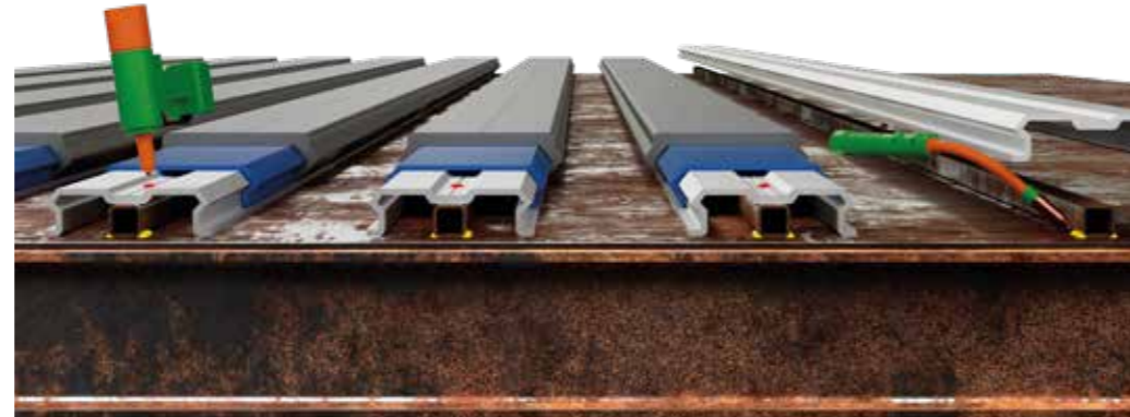
مولم يذالوف يقودنص عطاقم ىلع ةتبتشمل موينمولال نم ةبئاسلا ةيلفسلا موينمولال عطاقم يذالوف حولب
