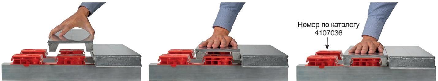
**Монтаж пола** обычно выполняется надеванием профиля на направляющие. Также возможен монтаж путем нажатия на профиль пола сверху до защелкивания. Этот способ удобен при ограниченном пространстве.
