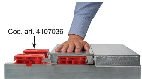
**Montaggio del pianale;** questo avviene normalmente facendo scivolare i profili del pianale. In alternativa si possono inserire dall'alto con un clic senza doverli far scivolare. Questo è molto pratico quando lo spazio è limitato.
