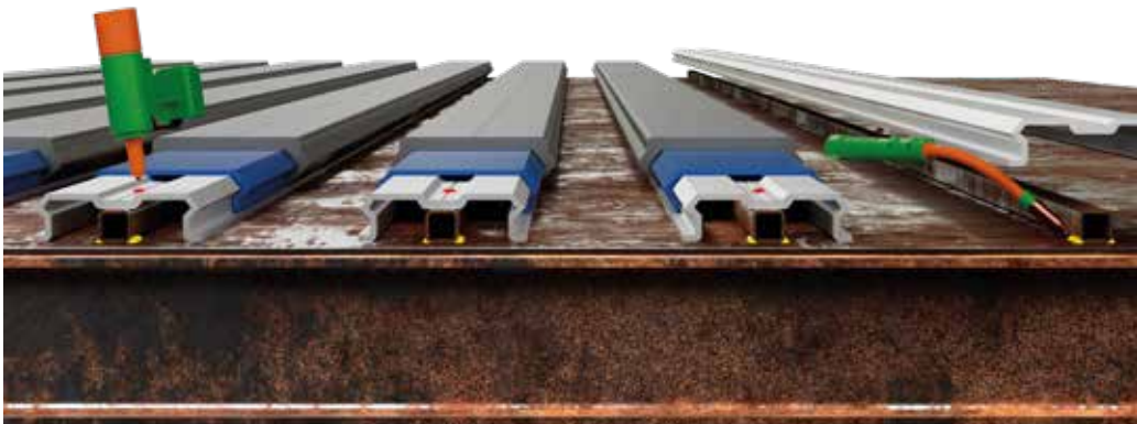
鋼板に溶接された鋼製ボックスセクションに、ルーズなアルミ製サブデッキ・プロファイルがリベット留めされている。
