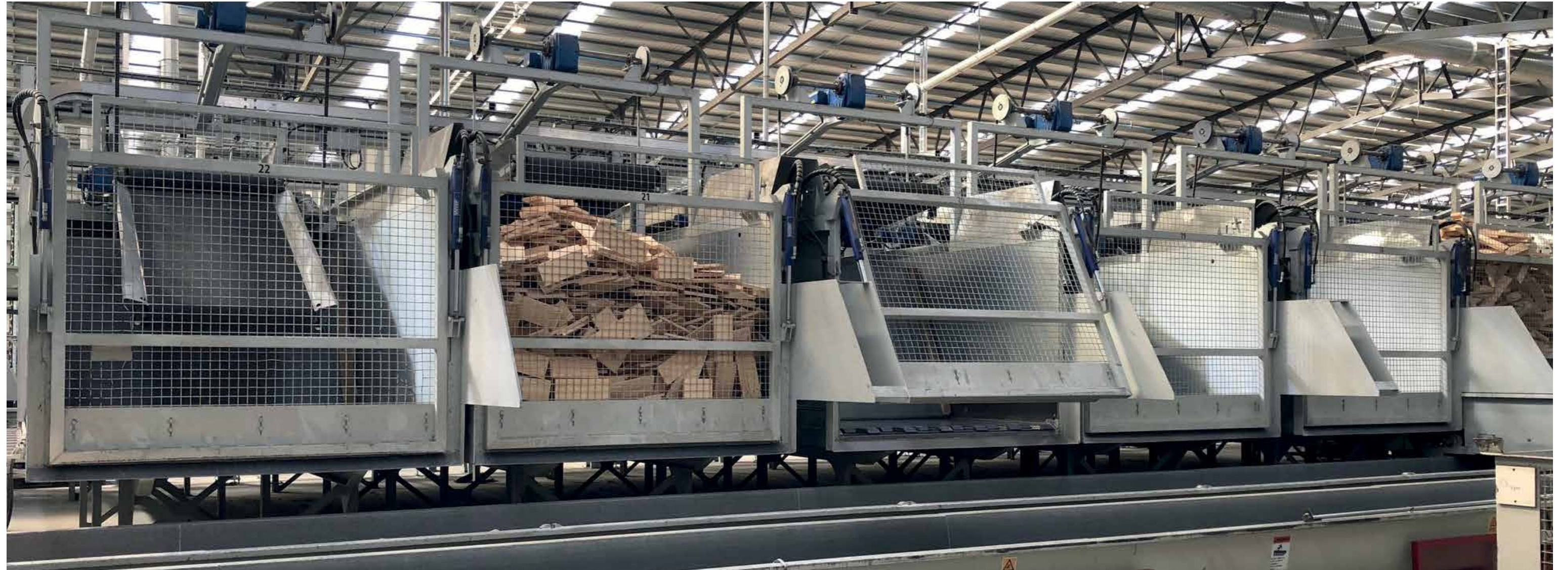
1단계: 세 개의 유압 실린더 모두 선택한 방향으로 바닥 전체를 이동하여 제품을 이동합니다.
