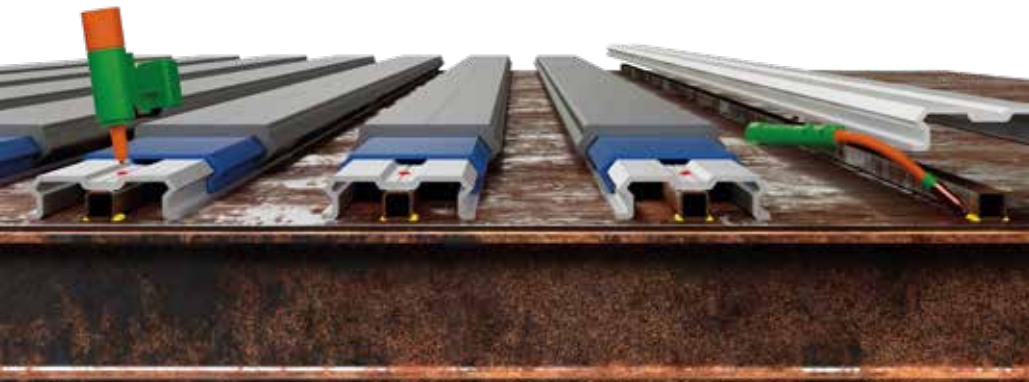
Lamas sueltas de aluminio para el subsuelo, remachadas a un perfil de acero en forma de caja soldado a una chapa de acero.
