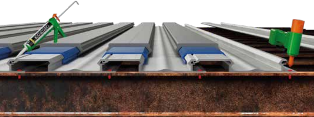
Listones de aluminio para el suelo de la plataforma inferior, del tipo «Slide in», remachados a travesaños de acero y sellados con sellador.
