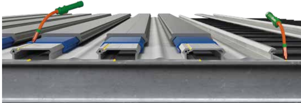
Listwy podłogowe podpokładu typu „slide-in” przyspawane do aluminiowych belek poprzecznych (lub nitowane), uszczelnione spoinami na całej długości.
