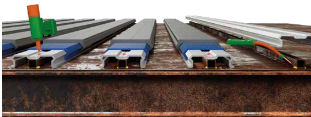
Luźne aluminiowe listwy podłogowe podpokładowe, przynitowane do stalowego profilu skrzynkowego przyspawanego do blachy stalowej.
