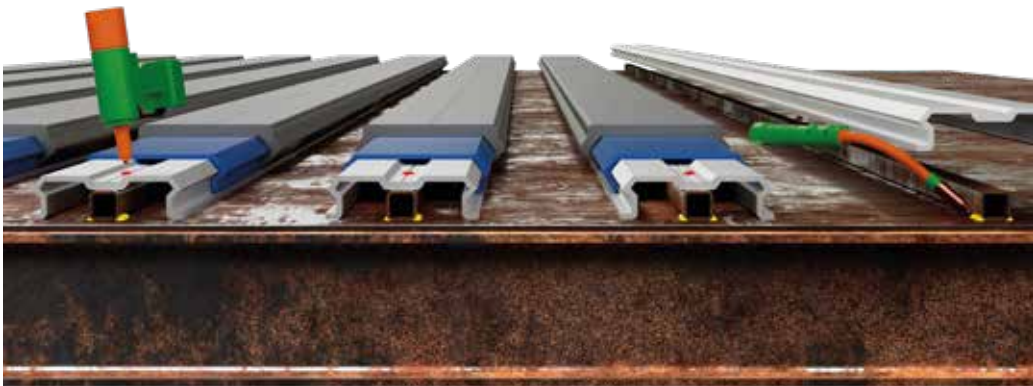
Doghe del sottopavimento in alluminio non fissate, rivettate su un profilo scatolare in acciaio saldato a una piastra in acciaio.
