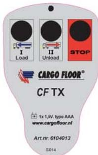
**Bouton n°1 (charger).** Une pression sur ce bouton va enclencher le chargement du système. Relâchez-le pour l'arrêter (ou appuyez sur le bouton rouge pour arrêter);
