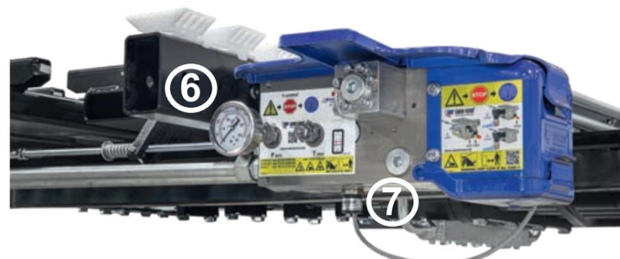
⑥ Манометр Cargo Floor 0-250 бар (подсоединяется непосредственно к контрольному клапану)
