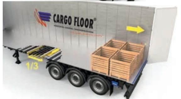
Шаг 1 повторяют, перемещая груз в нужном направлении. Время загрузки/разгрузки зависит от гидравлической системы, но обычное время цикла составляет 3-10 минут для прицепа длиной 13,6 м.
